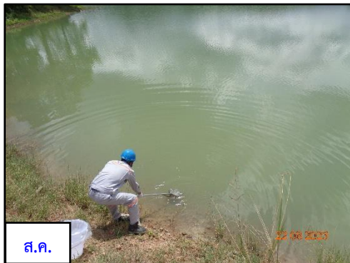
ภาพที่ 3.27 การตรวจวัดคุณภาพน้ำผิวดินบริเวณบ่อดักตะกอนของ West Dump
